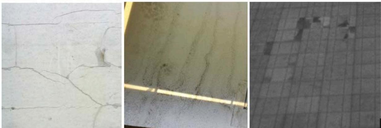
**Figura 1 – Difetti moduli fotovoltaici riscontrati tramite ispezioni visive ed elettroluminescenza**
